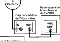
Para ver y grabar un canal codificado/ no codificado Sintonice el canal del Registrador de la combinación de TV/VCR en el canal de salida de la caja convertidora de televisión por cable (por ejemple el canal 3.) Después, seleccione en el decodificador de TV cable el canal que se quiera ver o grabar.
